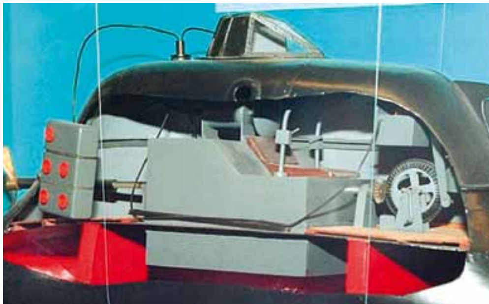
FOT. 1. Przekrój pierwszego „pedałowego” aparatu podwodnego Drzewieckiego, model z Centralnego Muzeum Morskiego w Gdańsku
