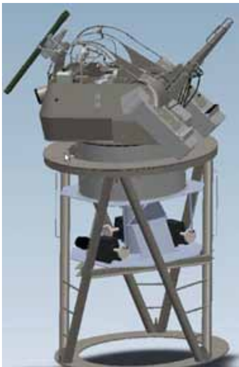
FOT. 4. Model stanowiska bojowego połączony z symulatorem stanu morza w laboratorium
